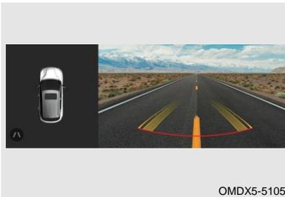
При переключении передачи на R линия траектории заднего хода динамически изменяется в зависимости от поворота рулевого колеса и используется для прогнозирования траектории движения задним ходом.
