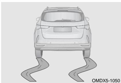
Быстрое ускорение на скользких дорожных покрытиях, таких как покрытые снегом или льдом дороги, может привести к проскальзыванию задних колес вправо или влево. Поэтому, пожалуйста, двигайтесь на малой скорости и действуйте осторожно.
