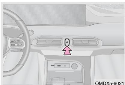
Нажмите переключатель аварийной сигнализации, одновременно замигают указатели поворота и индикатор указателей поворота на приборной панели; Нажмите переключатель еще раз, указатели поворота и индикатор погаснут.
