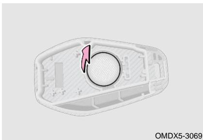
Шаг 3: С помощью отвертки, обмотав наконечник защитной лентой, снимите аккумулятор, а затем установите новую батарею.
