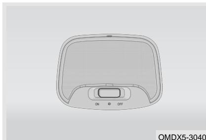
Переместите переключатель в положение «OFF», чтобы выключить задний плафон. Переместите переключатель в положение «ON», чтобы включить задний плафон. Когда переключатель находится в среднем положении, задний плафон включается/выключается в зависимости от открытия/закрытия двери.
