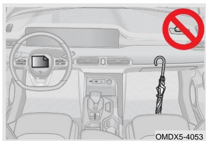
Ничего не прикрепляйте или прислоняйте к таким областям, как приборная панель, рулевое колесо и нижняя часть приборной панели. Эти предметы могут стать снарядами при срабатывании подушки безопасности водителя или переднего пассажира.
