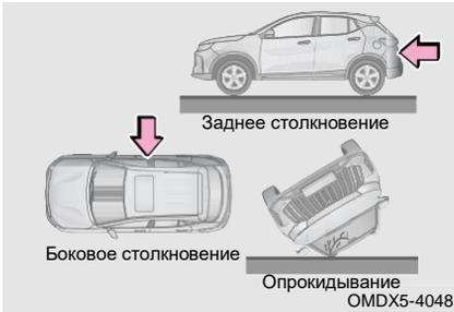
Передняя боковая подушка безопасности и шторка безопасности могут не сработать, если автомобиль подвергнется фронтальному или заднему столкновению, опрокидыванию или боковому столкновению на низкой скорости.
