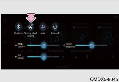
При ON питания напряжение батареи составляет 11,5 В или более; Запустите двигатель, сдвиньте экран аудиосистемы вниз, нажмите переключатель обогрева рулевого колеса, чтобы включить или выключить его.
