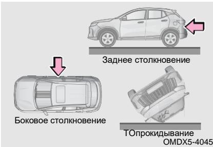
Подушка безопасности водителя и подушка безопасности переднего пассажира могут не сработать, или автомобиль попал в боковое или заднее столкновение, если он перевернулся или попал в лобовое столкновение на низкой скорости.
