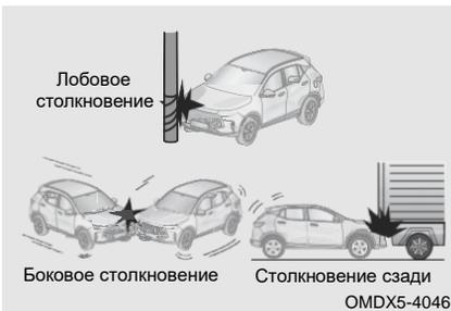
Подушка безопасности водителя и переднего пассажира могут не сработать, если передняя часть автомобиля ударится о телеграфный столб, попадет под грузовик или коснется бокового удара.
