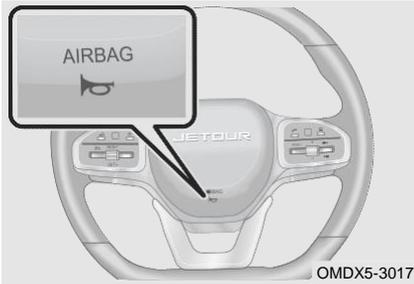
Чтобы подать звуковой клаксон, нажмите на область возле значка звукового клаксона на рулевом колесе.
