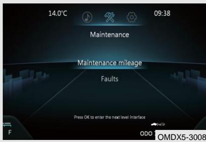
Настройка пробега для технического обслуживания: настройте пробег следующего интервала технического обслуживания.
