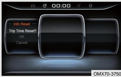
Очистка информации – это очистка информации о поездке, которая включает в себя следующие: сброс времени поездки, сброс A. V. S., сброс A.F.C., сброс поездки.
