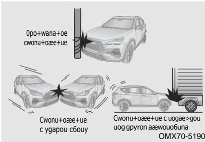
Фронтальная подушка безопасности водителя и фронтальная подушка безопасности переднего пассажира могут не сработать, если передняя часть автомобиля ударится о телеграфный столб, попадет под грузовой или коснется бокового удара.
