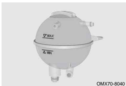
При холодном двигателе уровень охлаждающей жидкости должен находиться между отметками «MIN» и «MAX». Если уровень находится на отметке «MIN» или ниже нее, долейте охлаждающую жидкость и немедленно обратитесь на официальную станцию технического обслуживания Jetour для проверки и ремонта.
