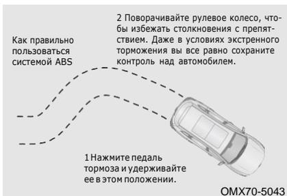
ABS не работает при обычном торможении и немедленно включается только при экстренном торможении (– педаль тормоза пульсирует с шумом, обеспечивая эффективность торможения и рулевого управления, если места достаточно, автомобиль также может объезжать препятствия). Никогда не отпускайте педаль тормоза в этом случае.
