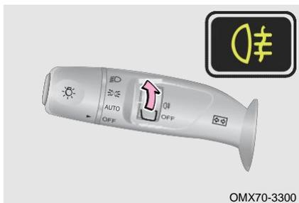
При переводе переключателя ENGINE START STOP в режим ON и включении ближнего света, переместите кнопку в положение «☞☞» один раз, чтобы включить заднюю противотуманную фару; переместите кнопку в положение «☞☞» еще раз, чтобы выключить заднюю противотуманную фару.
