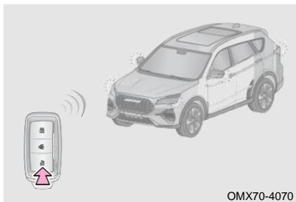
Нажмите кнопку разблокировки на смарт-ключе, или нажмите кнопку дверной ручки, или подойдите к автомобилю, неся смарт-ключ при себе, система автоматически распознает действительность смарт-ключа и автомобиль автоматически разблокируется, после чего автомобиль выходит из режима постановки на охрану.
