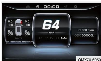
В системе контроля давления в шинах, когда давление в одной или нескольких шинах недостаточное или температура слишком высокая, «!» желтый индикатор на комбинированном приборе остается включенным.
