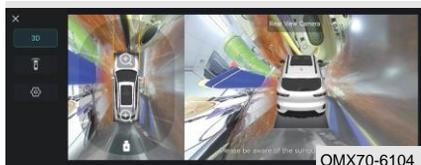
Нажмите кнопку «X», при этом рычаг переключения передач не находится в положении R, чтобы выйти из настройки системы монитора панорамного обзора.
