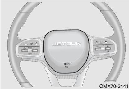
Чтобы подать звуковой сигнал, нажмите на область возле значка клаксона на рулевом колесе.
