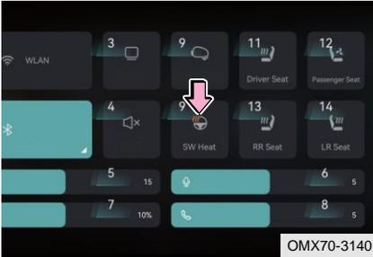
Нажмите переключатель, чтобы включить функцию обогрева рулевого колеса, при этом загорится индикатор. Нажмите переключатель еще раз, чтобы отменить функцию, и индикатор погаснет.
