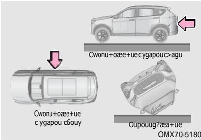
Фронтальная подушка безопасности водителя и фронтальная подушка безопасности переднего пассажира могут не сработать, если автомобиль попал в боковое заднее столкновение, перевернулся или попал в лобовое столкновение на низкой скорости.
