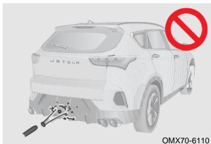
При мытье автомобиля используйте мягкую ткань или воду (низкое давление воды), чтобы смыть посторонние вещества, такие как снег, грязь и пыль, с поверхности радарного датчика.
