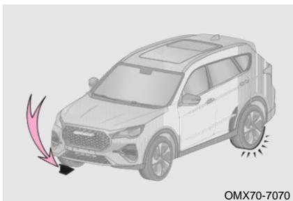
Поместите блок под шину по диагонали напротив спущенной шины, чтобы предотвратить скатывание автомобиля.
