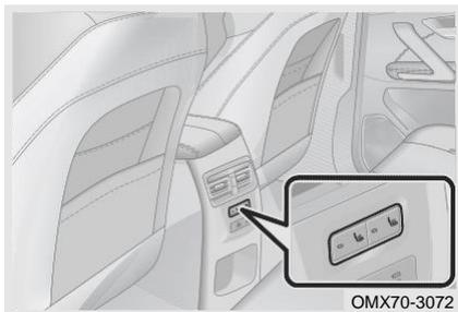
Переведите питание автомобиля в режим ON, нажмите кнопку подогрева сидений, чтобы включить подогрев задних сидений, и нажмите кнопку подогрева сидений еще раз, чтобы выключить подогрев задних сидений.
