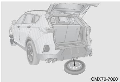
4. Снимите крюк устройства крепления запасного колеса и запасное колесо, когда запасное колесо будет опущено в самое нижнее положение.
